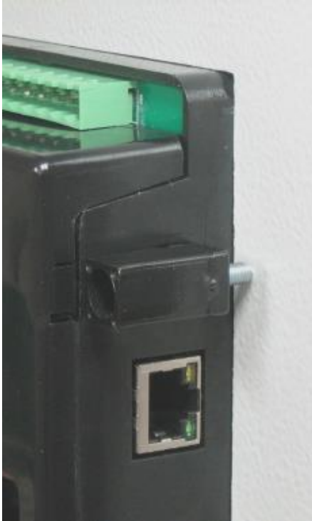
Vidalı tip braket montajı
