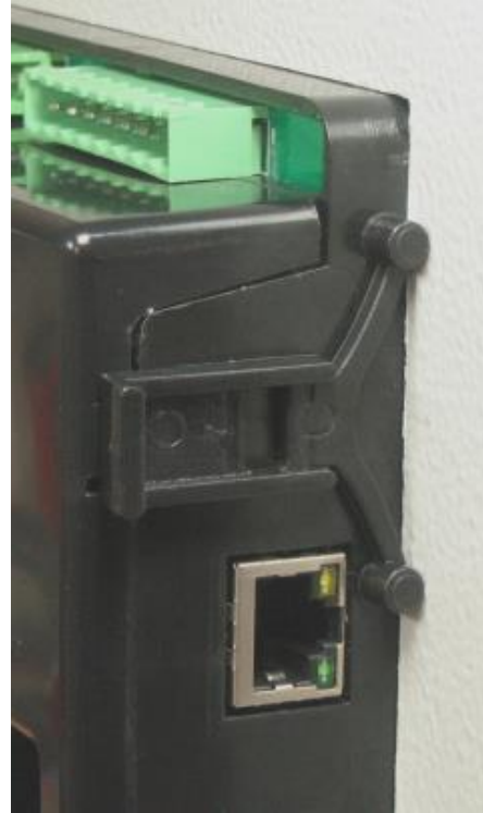
Yaylı tip braket montajı
